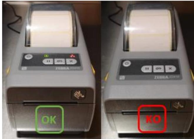
Figura 13. Comprobación de la conexión de impresora
